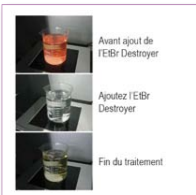
Traitement du BET sur support solide.
