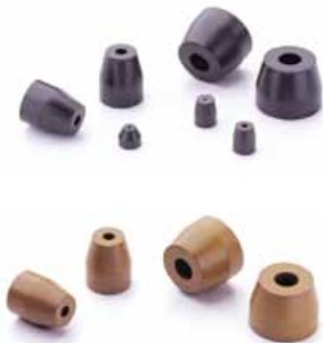
Les ferrules permettent l'étanchéité entre la colonne et le système. La ferrule idéale assure une étanchéité parfaite avec différents diamètres extérieurs de colonne, avec un serrage minimal, ne colle pas à la colonne ni aux raccords et supporte des cycles thermiques importants. Trois types de ferrules conditionnés par 10 unités :
