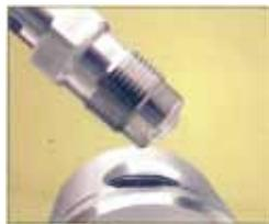
Continuer de dévisser l'écrou jusqu'à ce que l'ensemble du clapet se détache de la tête de pompe.
