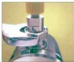
Placer la clé sur l'écrou hexagonal et tourner. L'écrou hexagonal tournera indépendamment du tube de connexion.
