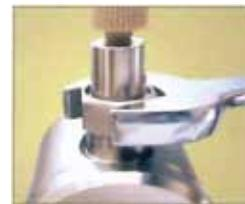
Réinstaller l'ensemble du clapet sur la tête de pompe et revisser.
