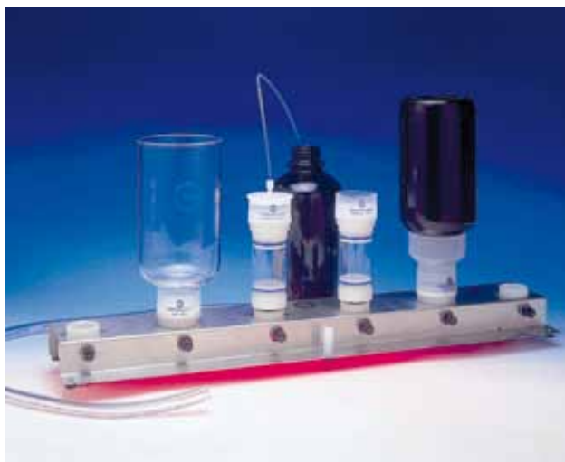
Station d'extraction Speedisk® 6 postes
