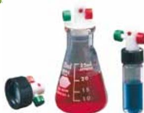
Ces flacons sont utilisés pour la collecte et le stockage des échantillons.
